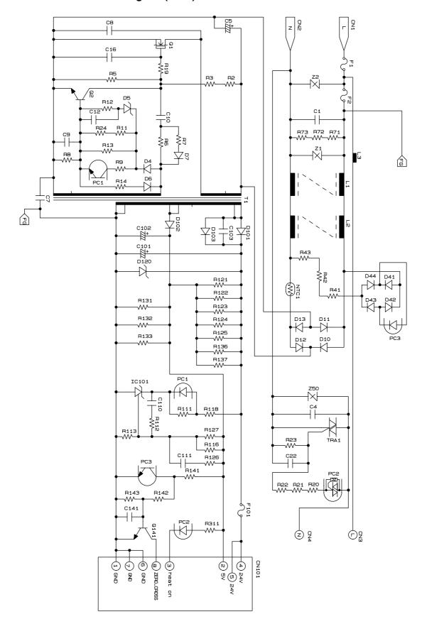
■ LVPS PCB Circuit Diagram (200V)
