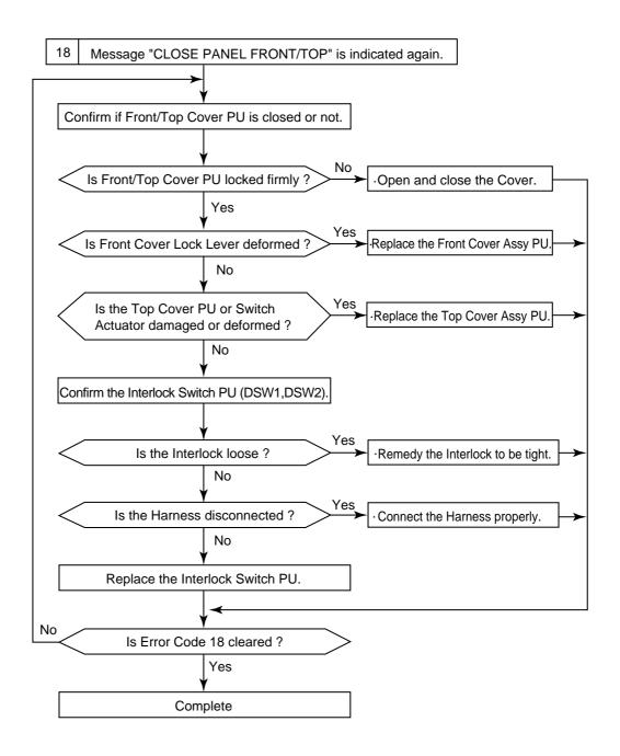
DSW1 : Front Cover Interlock Switch DSW2 : Top Cover Interlock Switch
